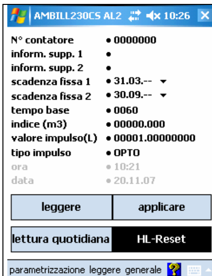
Fig. 47 „HL-Reset“ permette un ritorno alla parametrizzazione standard de 'AMBILL® 230 CS' Contattare il responsabile presso l'Aquametro, per maggiori informazioni
