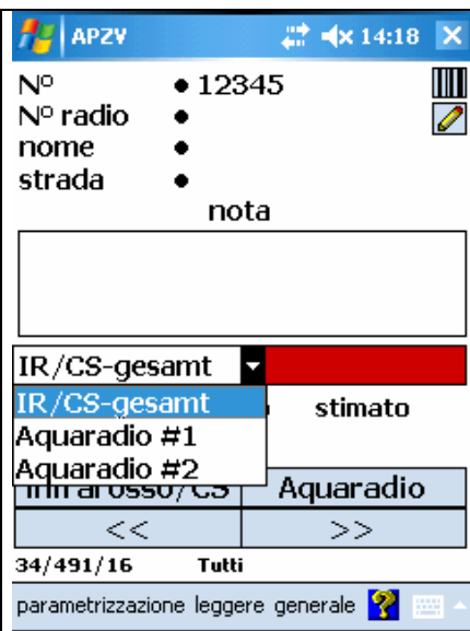
Fig. 77 Completare banca dati (numero radio, nome, via, note), inoltre indicare il tipo di lettura: infrarosso/CS, manuale o radio. Se lettura radio: indicare anche il canale (#1 / #2).
